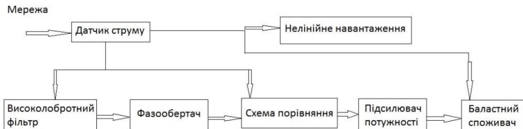
Рис. 2. Блок-схема пристрою стабілізації струму
