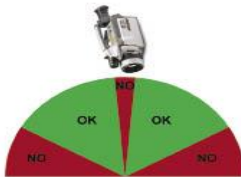
Рисунок 4 – Рекомендований кут огляду для тепловізійної камери
