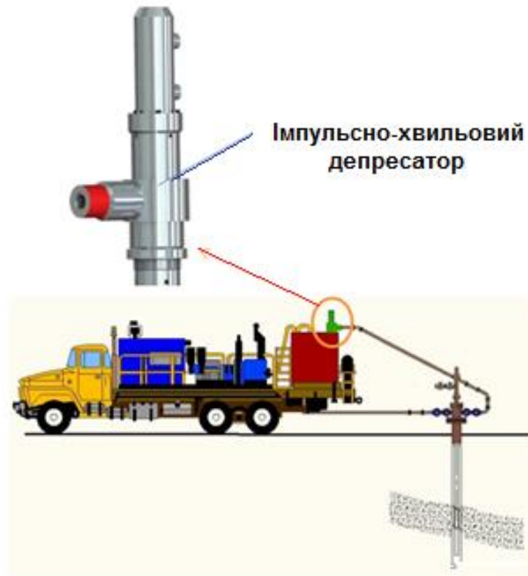
Рисунок 1 – Установка імпульсно-хвильового депресатора на насосному агрегаті ЦА-320
