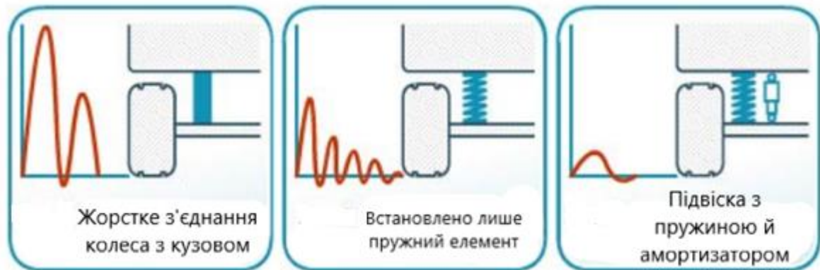
Рисунок 1 – Діаграми коливань автівки для різних з'єднань підвіски
