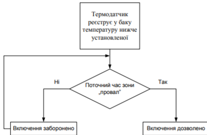
Рис.2 – Алгоритм управління електроводонагрівачем накопичувального типу
