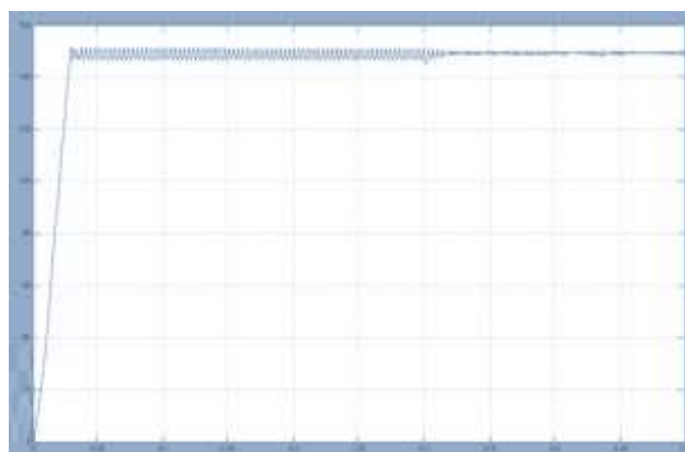
Рисунок 6. Частота обертання ротора зі змінним моментом навантаження
