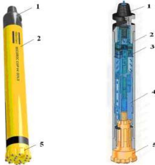
Рис 2. Загальний вигляд і конструкція заглибного пневмоударника бурового станка "Atlas Copco".
