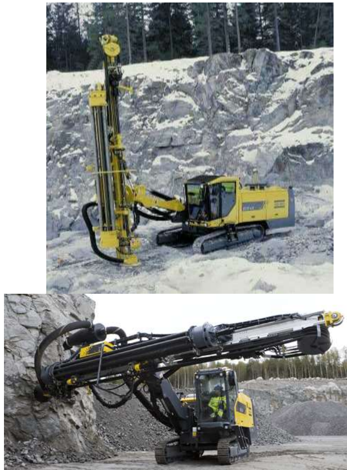
Рис.1 Буровий станок "Atlas Copco" для буріння на кар'єрі свердловин: а – вертикальних, б – горизонтальних.
