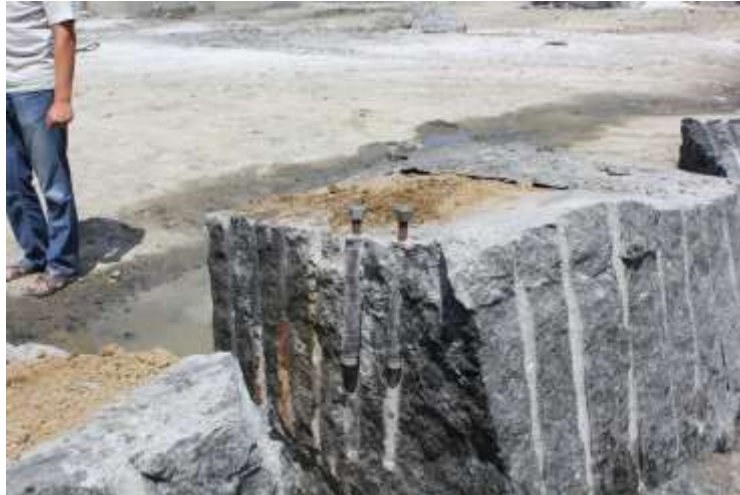
Рисунок 5. Загальний вигляд блоку, розколотого статико-динамічним методом.
