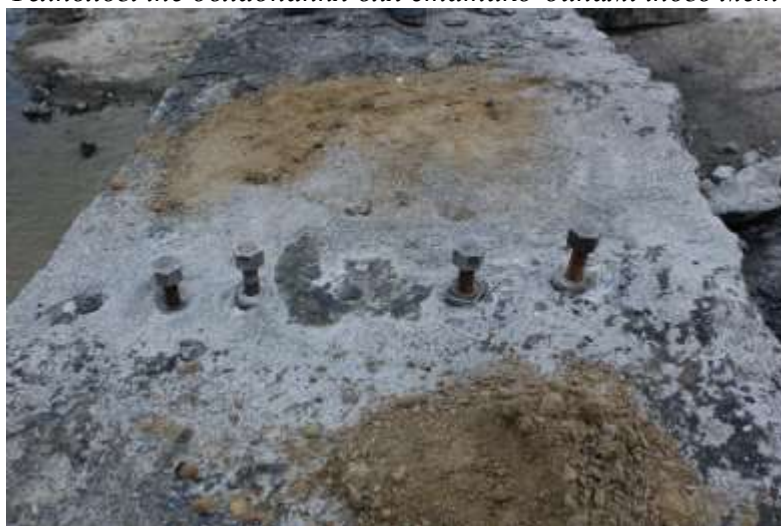
Рисунок 3. Загальний вигляд агрегатів після досягнення статичного тиску порядку 30МПа.
