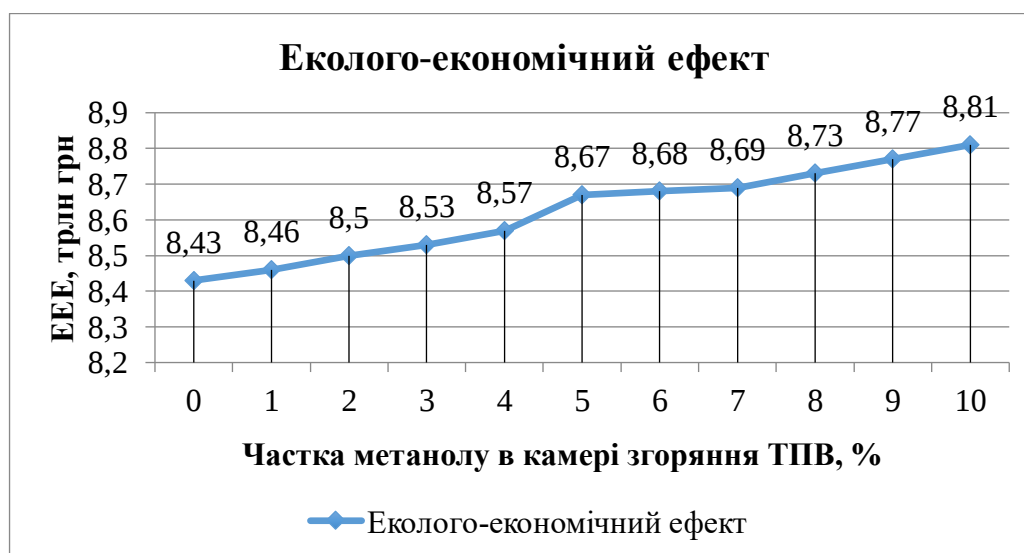
Рисунок 2 – Залежність еколого-економічного ефекту від частки використання метанолу в камері згоряння ТПВ
