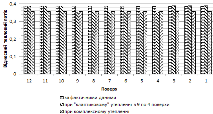
Рисунок 2 – Відносні теплові потоки ОП, які розташовані на різних поверхах в залежності від виду утеплення
