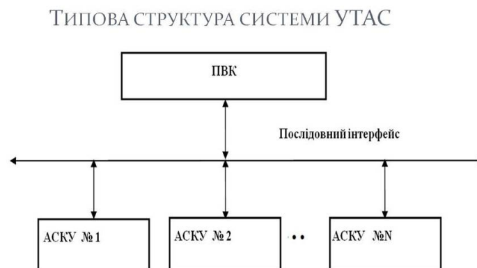
Рисунок 3 Типова структура ситеми УТАС
